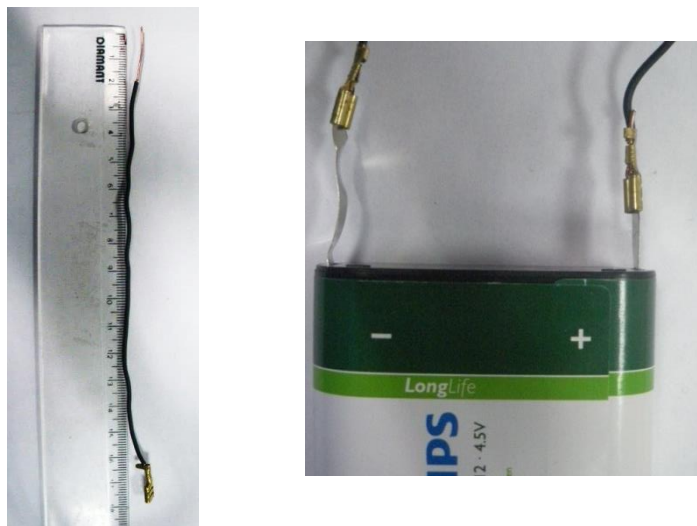
Εικόνα 3. (a),(b) Τα μονωμένα αγώγιμα καλώδια από χαλκό τα οποία χρησιμοποιήθηκαν για την σύνδεση με την πηγή τροφοδοσίας.
